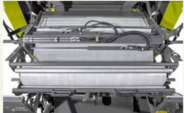
Die Mantelfolie wird beim Binden aktiv vorgespannt.
