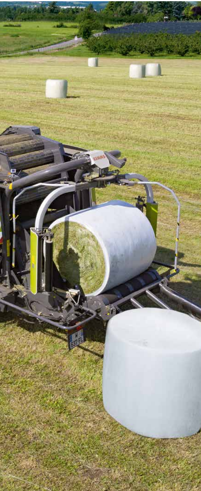
Die Mantelfolie wird beim Binden aktiv vorgespannt.
