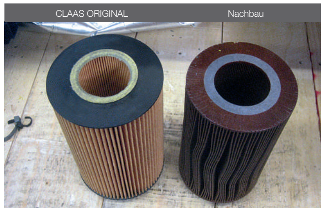
Links ein neuer CLAAS ORIGINAL Filter, rechts ein defekter Nachbau-Filter (Laufzeit <20 Std.) Im Vergleich ist zu erkennen, dass beim Nachbau-Filter keine Dichtung vorhanden ist. Dadurch kommt es zu inneren Leckagen, die im Motorbetrieb nicht wahrgenommen werden können, da Öldruck vorhanden ist. Infolgedessen kommt es zu einer Paketbildung des Filterpapiers, die zum Kollabieren des Filters führen kann.
