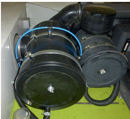
Ringmessleitung am Luftfiltergehäuse misst Differenzdruck vor dem Filter.
