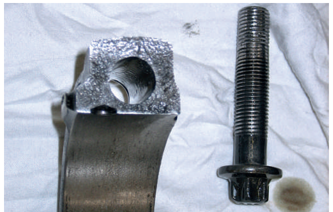
Pleuellagerdeckel mit beschädigten Trennbruchflächen.
