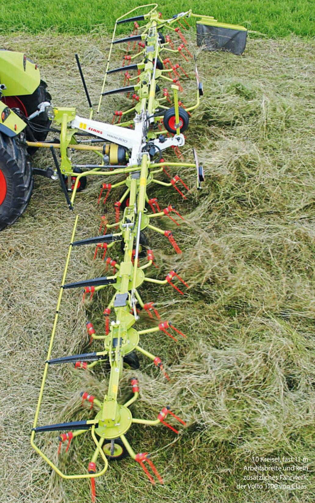
10 Kreisel, fast 11 m Arbeitsbreite und kein zusätzliches Fahrwerk: der Volto 1100 von Claas.
