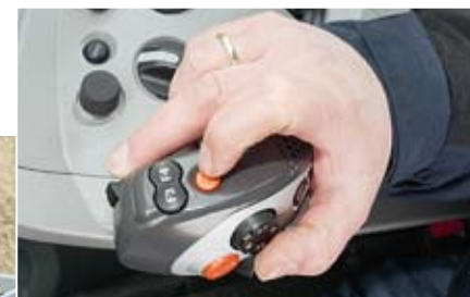
Ganz neu ist das Bedienkonzept: Der Multifunktionsgriff für mehr als 20 Funktionen wird mit drei Fingern bedient. Je nach Fahrer-Erfahrung können im Cebis-Monitor die Untermenüs in drei Ebenen freigeschaltet werden (Anfänger, Profi, Experte).
