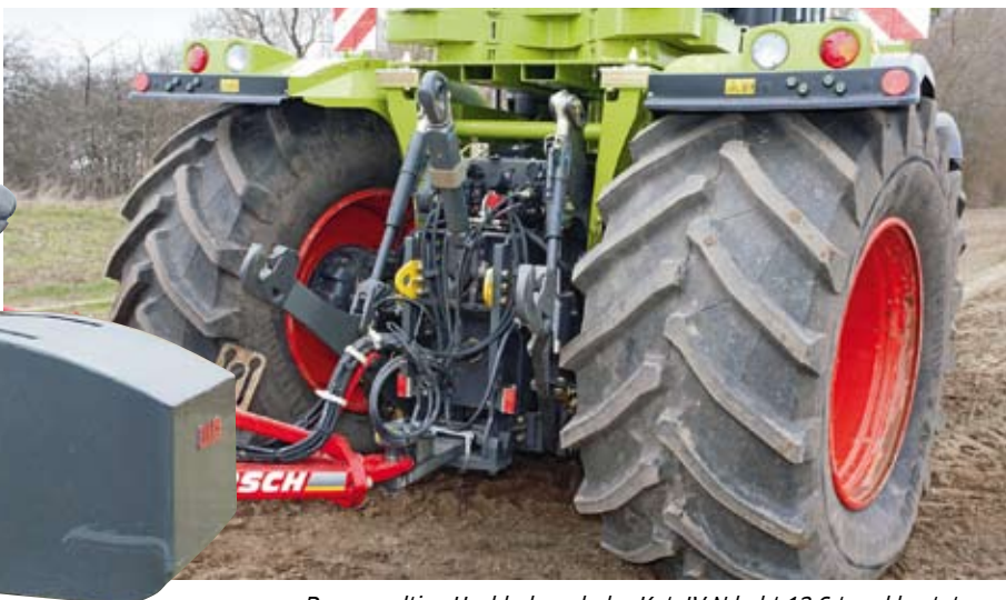
Das gewaltige Heckhubwerk der Kat. IV N hebt 13,6 t und kostet rund 10000 Euro extra. Hinten gibt es bis zu sechs Steuerventile – natürlich alle mit Zeit- und Mengensteuerung.
