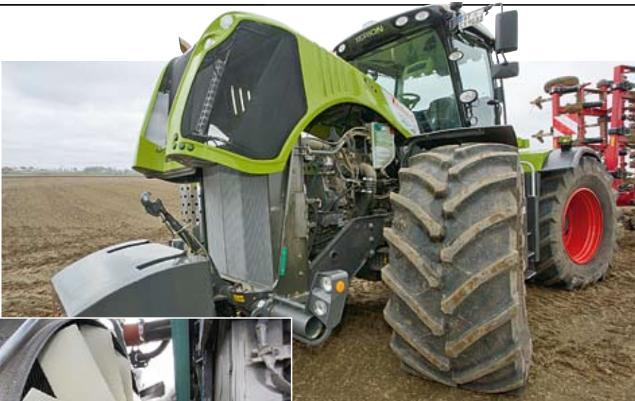
Unter der mächtigen Haube arbeitet der C 13 von Caterpillar. Eine Besonderheit sind die hydraulisch angetriebene Lüfter und die zwei Lichtmaschinen für das 12- und 24-Volt-Bordnetz.
