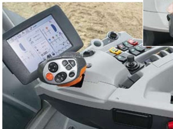
Ganz neu ist das Bedienkonzept: Der Multifunktionsgriff für mehr als 20 Funktionen wird mit drei Fingern bedient. Je nach Fahrer-Erfahrung können im Cebis-Monitor die Untermenüs in drei Ebenen freigeschaltet werden (Anfänger, Profi, Experte).
