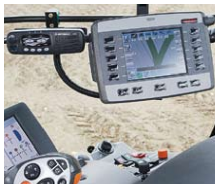
Das „Cebis Mobile“ ist ISO-fähig. Hier wird auch das neue GPS-Lenkensystem (in Zukunft auch mit RTKnet) bedient.
