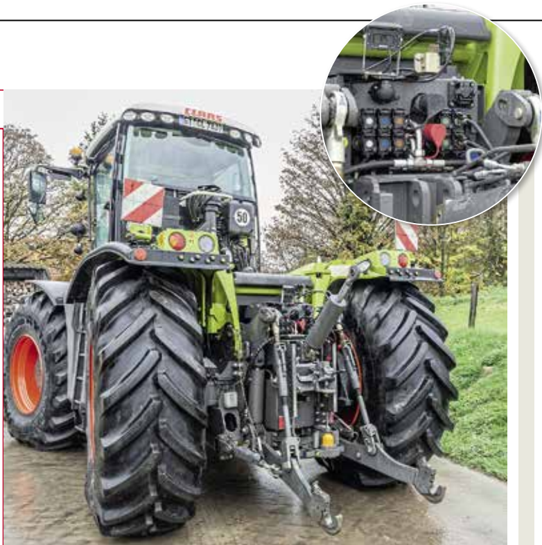
Trotz 2,15 m Pneu dreht der Xerion (dank gelenkter Hinterachse) auf 16,50 m. Hubkraft und Ölfördermenge gibt es satt. Die Bedienung sitzt allerdings auf den (zu) kurzen Kotflügeln in 2 m Höhe. Und die Ölschlüsse weit vorne...
