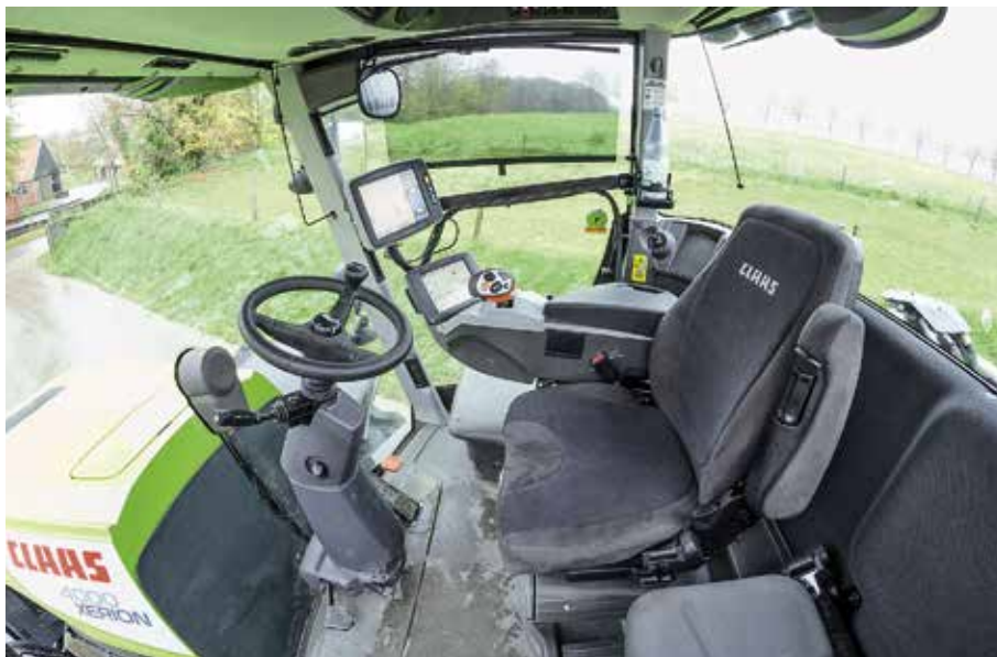
Die Kabine ist kurz, beim Blick nach hinten stört die Lenksäule, und es fehlte ein drehbarer Sitz. 71 dB(A) sind allerdings super, und auch der Komfort für Fahrer und Beifahrer kommt nicht zu kurz.
