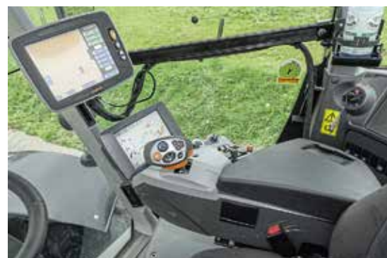
Der Cmotion-Hebel hat sich bewährt, die Cebis-Bedienung mit Hotkeys braucht Übung, geht dann aber super. GPS und ISO-Bus brauchen ein separates Terminal wie hier das S 10.
