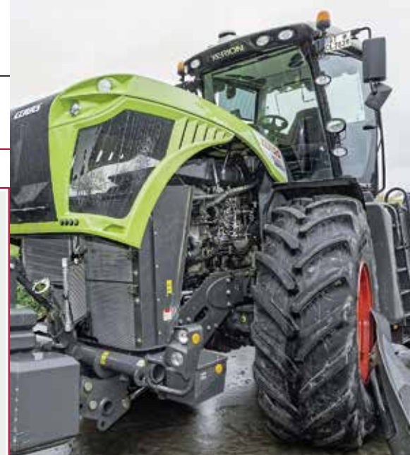
Unter der mächtigen Motorhaube sitzt der Mercedes mit 10,6 l Hubraum. Leistung und Verbrauch waren top – und schon das Fronthubwerk stemmt 7,7 Tonnen!
