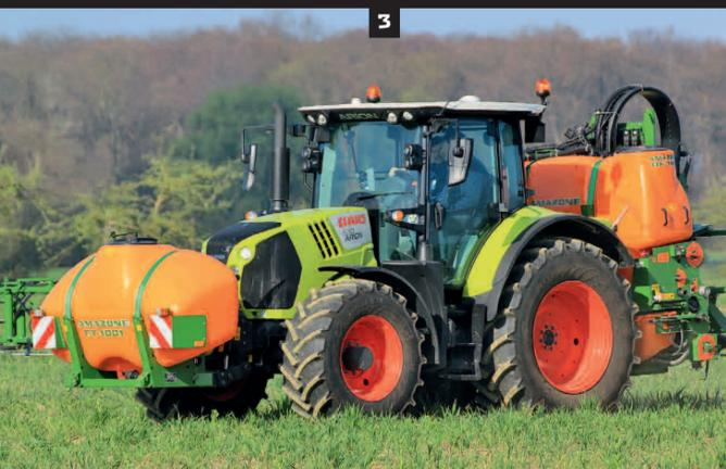
**Motor:** DPS PSS, Tier 4 final, Common-Rail, 4,5 l 4-Zylinder in Arion 500, 6,8 l 6-Zylinder in Arion 600, Abgasnachbehandlung mittels EGR+DPF+DOC+SCR, Dieseltank 200/215 l (500) und 285 l (600) optional 370 l, AdBlue-Tank 16 l
