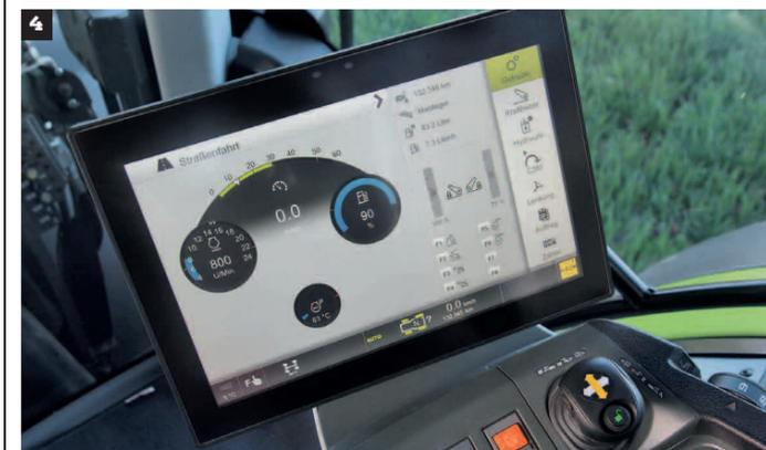
**3** An der Axion Kabine hat sich nichts verändert. Auf dem CMotion-Fahrhebel liegen nun acht F-Tasten. Der Fahrtrichtungswechsel kann frei belegt werden.
