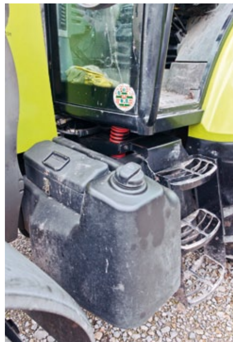
Beim Dieselverbrauch liegt das Aggregat etwas höher als vergleichbare Wettbewerber, die 330 l Dieselvorrat sind dafür okay.
