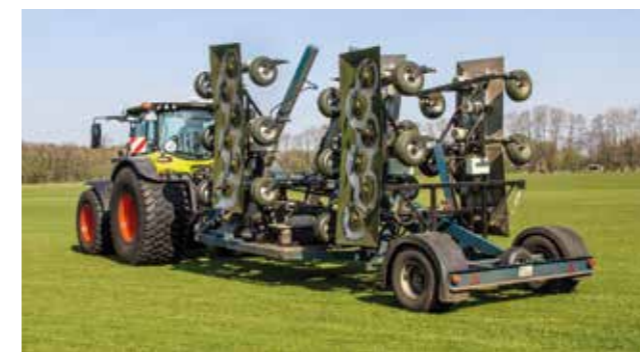
Im 10 m breiten Rasenmäher arbeiten 30 kleine Sichelmäher.
