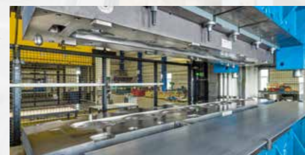
Blick in die Presse: Oben befindet sich die Matrize, unten der Stempel mitsamt Niederhalter.
