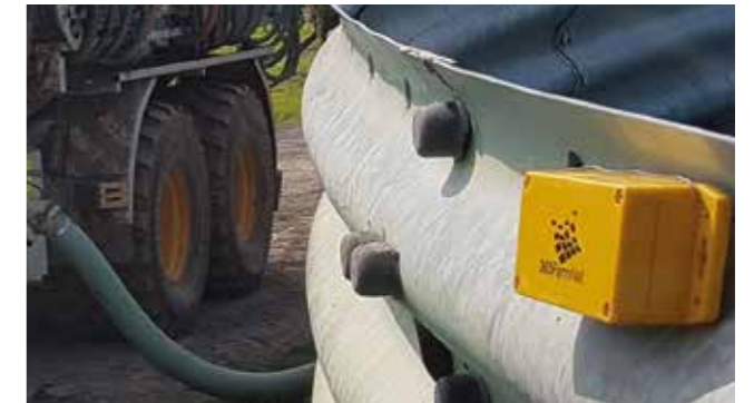
Mit 365ActiveBoxen am Güllebehälter sowie am Zubringer- und Ausbringfass lässt sich die Anzahl der ausgebrachten Fässer schlaggenau dokumentieren.
