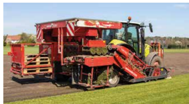
Die Schälmaschine schneidet die Rasensoden sauber ab, formt sie zu Rollen und packt sie direkt auf Paletten.
