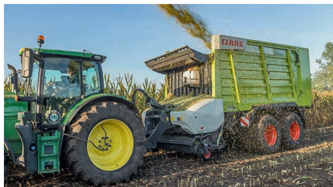
Als Häckseltransportwagen konnten wir bis zu 14 t Silomais zuladen. Der Rotor und die Dosierwalzen können dafür ausgebaut werden.
