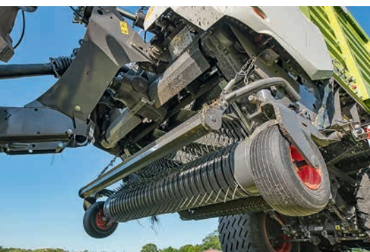
Mit 1,72 m leistet die hydraulisch angetriebene Pickup saubere Arbeit, auch bei kurzem Futter.
