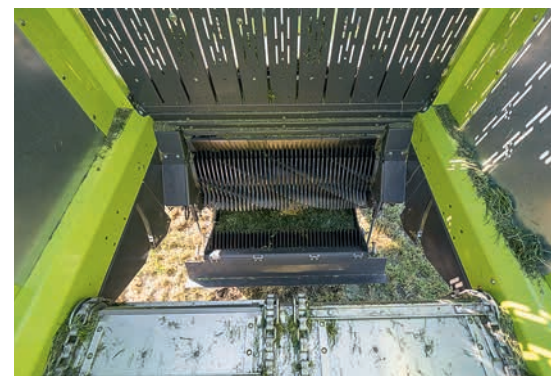
Die abgesenkte Schneidmulde gibt den Weg für Verstopfungen und zum Rotor frei.
