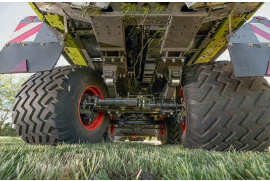
Das parabelgefederte Achsaggregat ist für 18 t ausgelegt. Die Bereifung ist Option.
