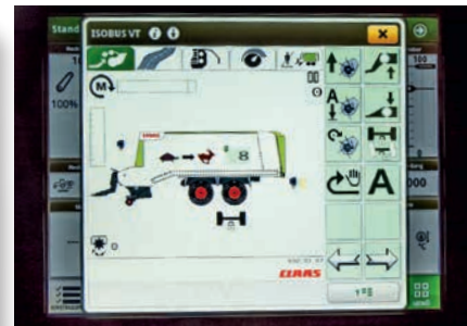
Bedient wird der Wagen per Operator (links) oder direkt per ISO-Bus rechts.
