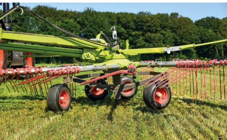
Die Kreisel des Vierkreiselschwaders sind so aufgehängt, dass die Zinken beim Ausheben und Einsetzen nicht in die Grasnarbe einstecken können.
