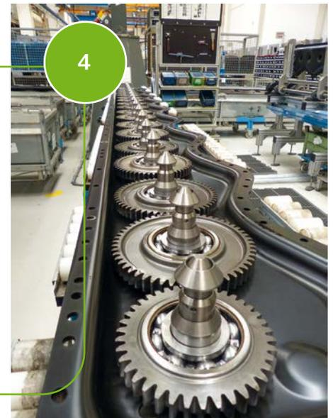
Hier sind bereits die Zwischen-räder eingelegt. Die Gehäusedich-tung wird mit Hilfe einer Schab-lo-ne passgenau aufgebracht. An-schließend werden Deckel und Wanne verschraubt.
