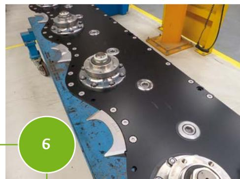
Der fertig montierte Balken. Nach einer Dich-tigkeitsprüfung wird er mit Öl be-füllt. Dieses muss wäh- rend der gesam-ten Lebens-dauer nicht ausgetauscht werden.
