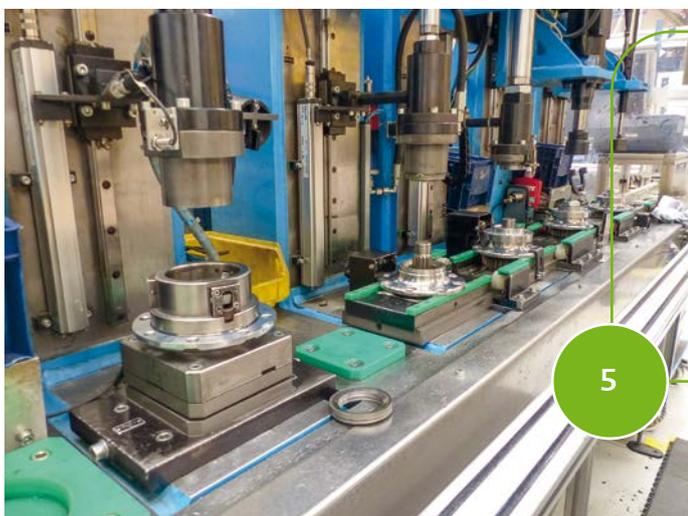
Die Safety Link-Module werden vormontiert.
