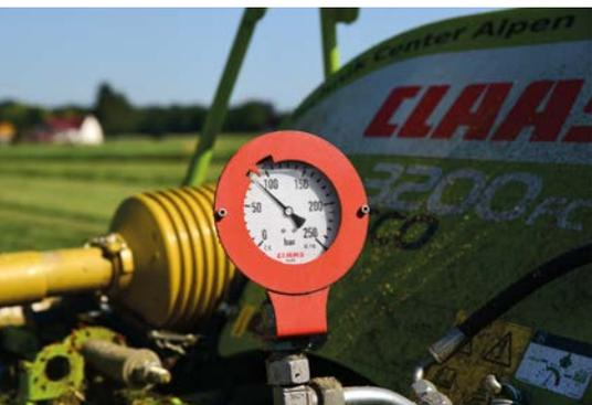
Der Auflagedruck lässt sich über ein Manometer bei vielen Mähwerken kontrollieren. Der Ziel- druck ist bei den Claas-Mähern mit einem roten Pfeil markiert.
