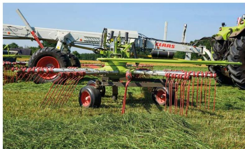
Der Rahmen des Schwaders muss möglichst parallel zum Boden ausgerichtet sein. Das ist hier nicht der Fall. Die Heckhydraulik des Schleppers sollte entsprechend angehoben werden.
