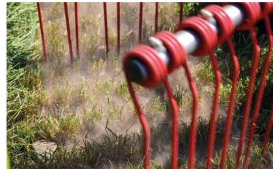
Ein Schwader ist kein Bodenbearbeitungsgerät – in der Praxis sieht man aber immer noch zu tief eingestellte Schwader. Die Folge: erhöhte Aschegehalte im Futter.
