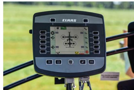
Bei Schwadern wie bei dem Liner 3600 kann die Rechhöhe bequem aus der Kabine heraus über das ISOBUS-Terminal eingestellt werden.
