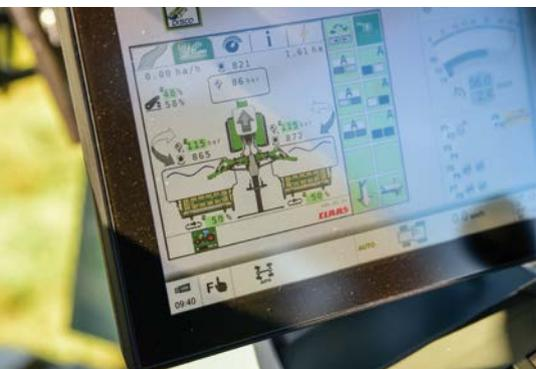
Über das ISOBUS-Terminal lässt sich bei der Profi-Mähkombination neben den Auflagedrücken, die Drehzahl der einzelnen Mäher sowie der Bänder der Schwadzusammenführung einstellen bzw. überwachen.
