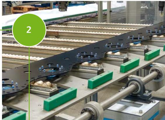
Die Schrauben werden form-schlüssig eingepresst. Dadurch ergibt sich ein Nieteffekt.
