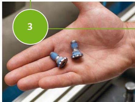
Verwendet werden spezielle Rändel-schrauben. Die Verschraubungen erfolgen computergestützt nach einem speziellen Schema und mit definierten Anzugs-momenten.
