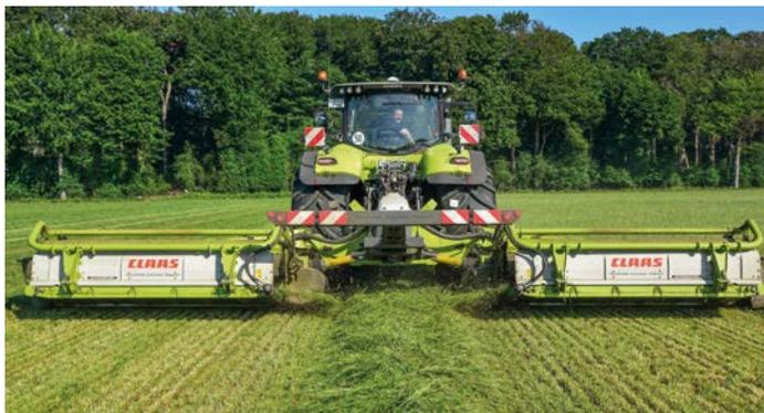
Die Hightech-Triplekombination bietet flexible Einsatzmöglichkeiten. Trotz der montierten Schwadzusammenführung – hier im Einsatz – klappt mit dem Disco 9200 C Autoswather auch die Breitablage sehr gut.
