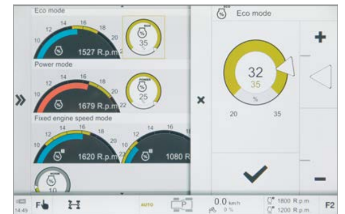
Einstellung der Motordrücke für „Eco“ und „Power“, sowie den Motordrehzahlspeicher.
