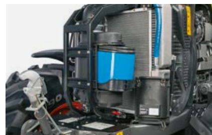
Der vor dem Kühler platzierte Motorluftfilter ist vom Boden aus sehr gut erreichbar.
