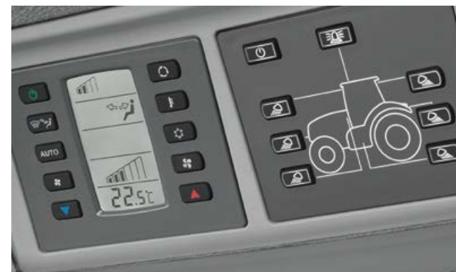
Neben der manuellen Klimasteuerung ist auch eine vollwertige Klimaautomatik erhältlich, die den Luftstrom angenehm in der Kabine verteilt.
