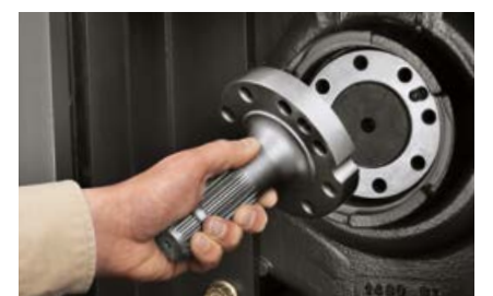
Einfacher Wechsel der Zapfwellenstummel
