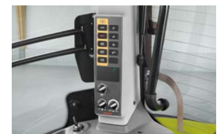
Zapfwellengeschwindigkeiten und elektronische Kraftheberregelung am B-Holm einstellbar
