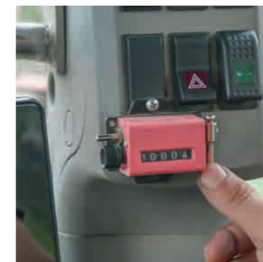
Der selbst eingebaute Fahrtenzähler sorgt für eine gute Übersicht.
