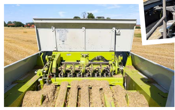
Das Herzstück bilden die je sechs Knoter: Der patentierte Einfachknoter lässt beim Bindevorgang keine Garnschnipsel zurück.
