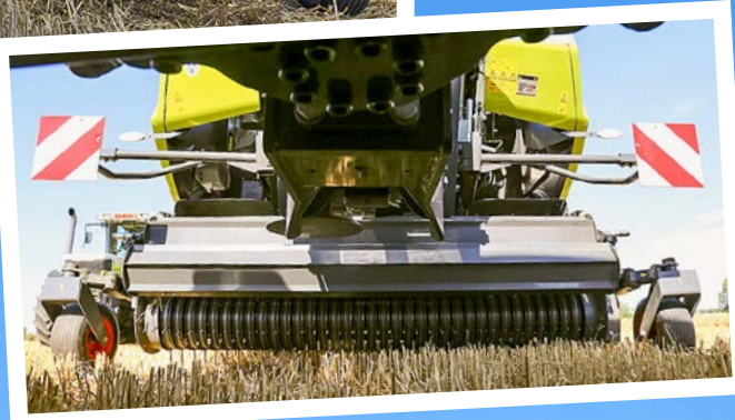
Plus 25 cm: Das Pickup-Design der Quadrant 5200 stammt vom Jaguar und ist deutlich breiter als bei der 2200er.
