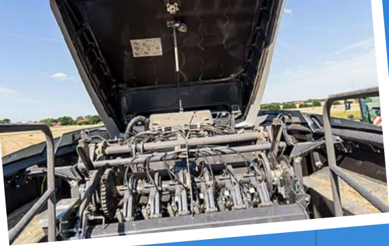
Das Herzstück bilden die je sechs Knoter: Der patentierte Einfachknoter lässt beim Bindevorgang keine Garnschnipsel zurück.
