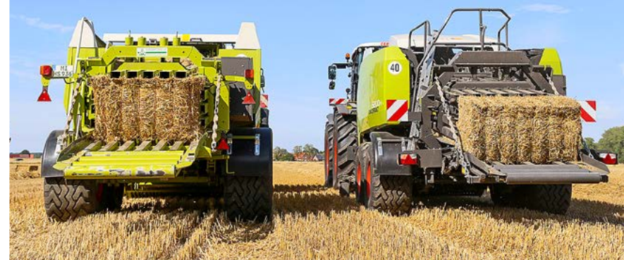
Identisches Ballenmaß und beide mit Rollenschurre – dafür weiß die moderne Quadrant 5200 dank Sensorik mehr über den aktuell gepressten Ballen.
