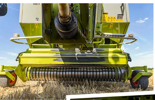
Plus 25 cm: Das Pickup-Design der Quadrant 5200 stammt vom Jaguar und ist deutlich breiter als bei der 2200er.
