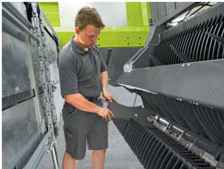
Einfacher Messerwechsel durch Abklappen des Kratzbodens.
