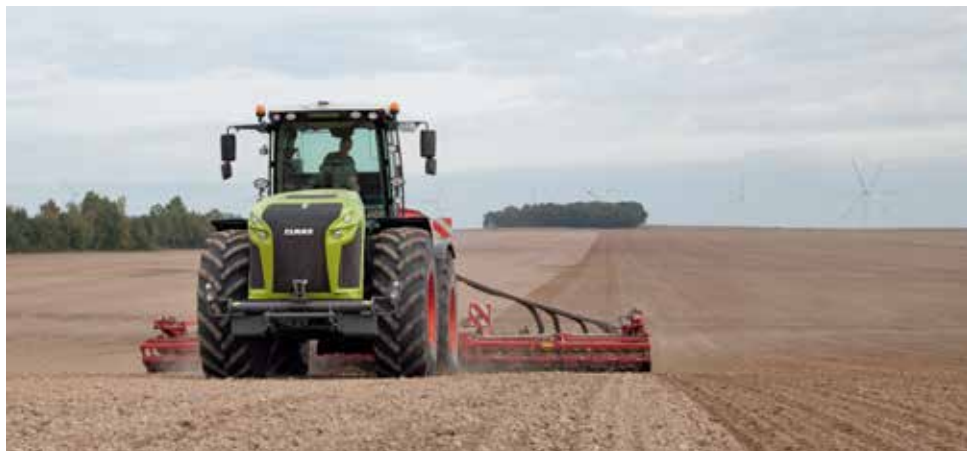
Mit der 9 m breiten Pronto DC schafft der XERION auf den großen Schlägen der AFB Agrar GmbH rund 9 ha pro Stunde – inklusive Nebenzeiten. Dazu Fahrer Uwe Fröbe: „Mit dem Tier 4f Mercedes-Motor verbraucht der neue XERION bei der Säarbeit rund 0,5 l weniger Kraftstoff pro Hektar.“
