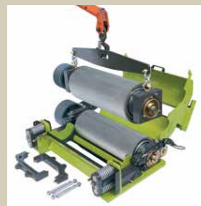
MULTI CROP CRACKER mit tauschbaren Walzenmänteln
