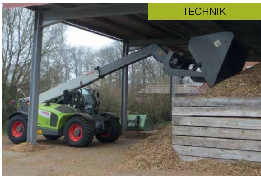
Der Drehpunkt der Hochkippschaufel (HKS) liegt fast vorne an der Schneide. So benötigt man weniger Entladehöhe
