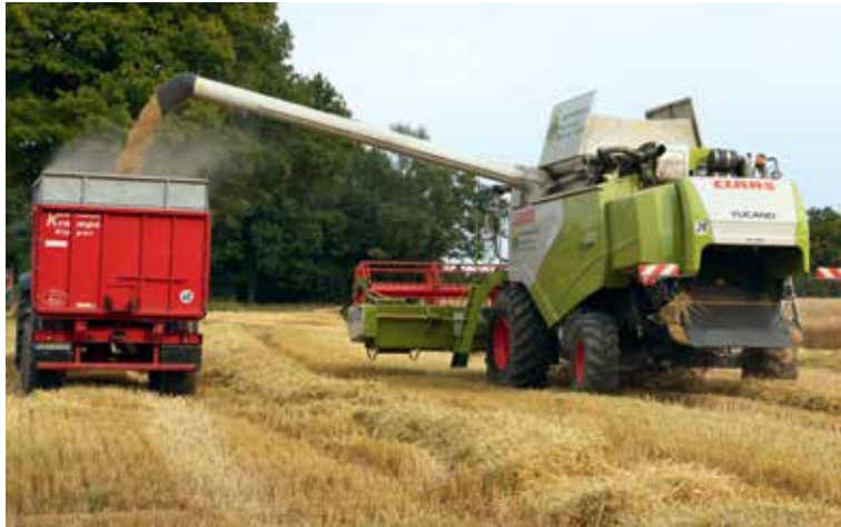
Die Obenentleerung schafft eine höhere Abtankleistung und erleichtert das Überladen auf hohe Abfuhrfahrzeuge.
