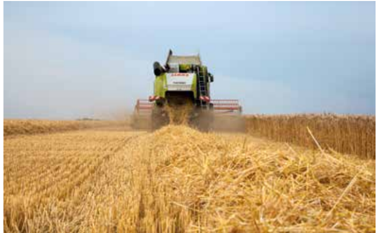
Wird mit niedrigen Rotordrehzahlen gearbeitet, ist die Strohqualität sehr gut.
