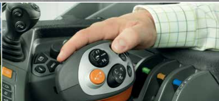
Die TREND Modelle lassen sich bequem über die Ventile am Fahrhebel steuern.
