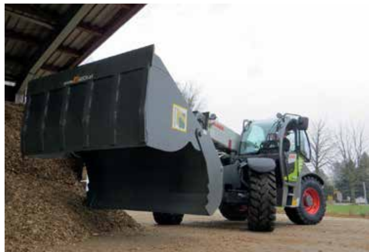
Die „4-in-1-Schaufel“ kann schaufeln, greifen, planieren und abziehen.
