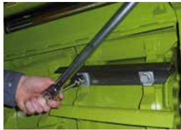
Messermontage mit Drehmomentschlüssel
