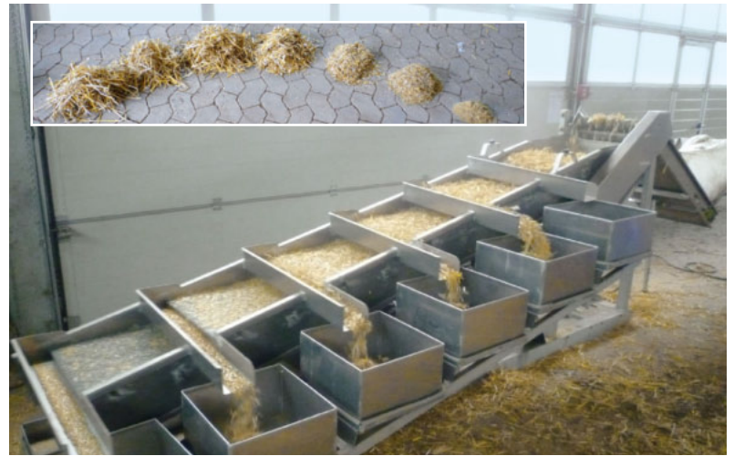
In Triesdorf wurde bei den Untersuchungen auch das Stroh analysiert und in verschiedene Fraktionen unterteilt bzw. gesiebt.
