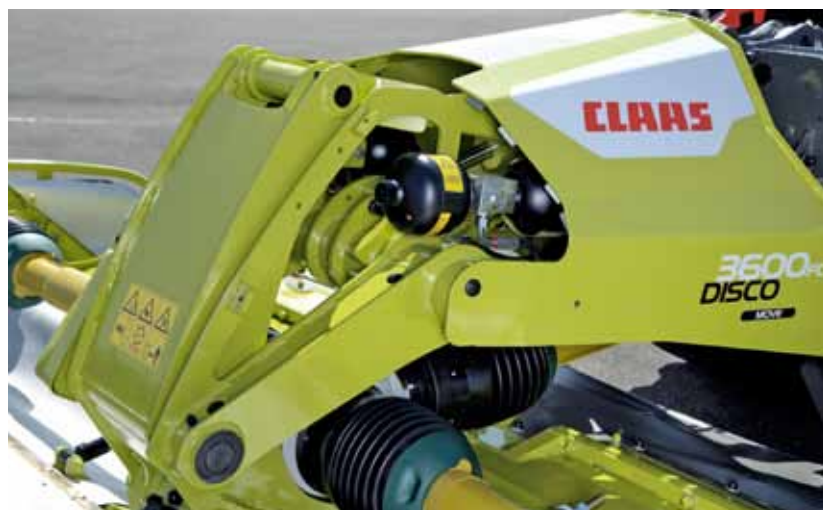
Blick auf die Kinematik mit vorderer Schwinge und Druckausgleichsbehältern bei demonstrierter Abdeckung. Hier wird die untere Lenkerfunktion der Haube deutlicher sichtbar.
