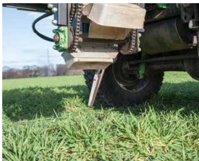
Schräg nach hinten wird der Stecharm wieder aus dem Boden herausgezogen. Währenddessen senkt sich automatisch ein Probenahmebehälter ab.
