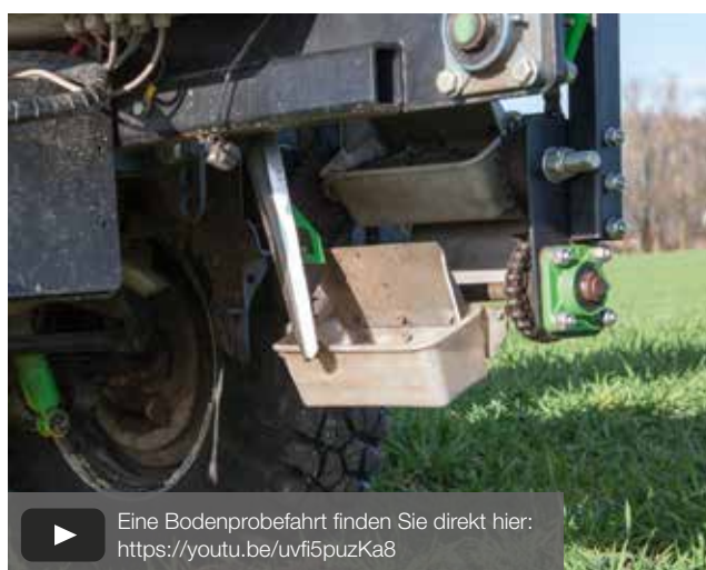
Auf Höhe des Probenahmebehälters schiebt sich ein Auskratzer durch die Nut des Stechars, sodass die Teilprobe in den Behälter geworfen wird.
